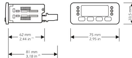
(1) profondeur maximum avec borniers à vis (sur demande)
