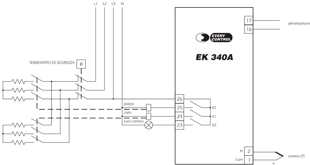
(7) dotare la sonda di una protezione in grado di isolarla contro eventuali contatti con le parti metalliche o utilizzare una sonda isolata.
