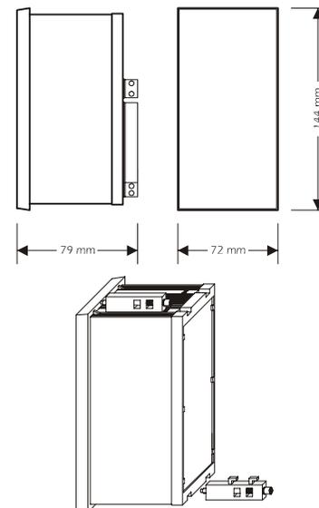
installazione con staffe a vite; per evitare di danneggiare il contenitore e le staffe a vite, modellare la coppia di serraggio.
