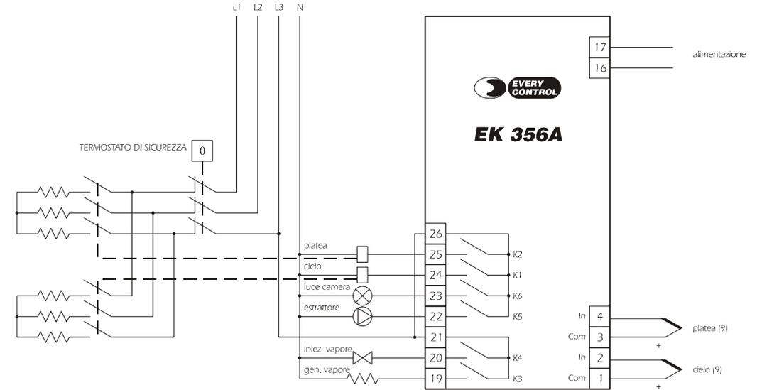
(9) dotare le sonde di una protezione in grado di isolarle contro eventuali contatti con le parti metalliche o utilizzare sonde isolate.
