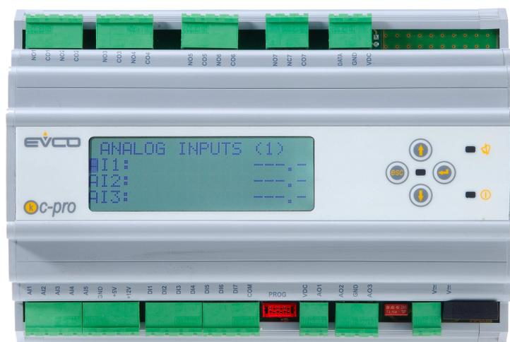
Il display è composto da un visualizzatore alfanumerico 4 x 20 caratteri, la tastiera da 6 tasti; 3 LED completano l'interfaccia utente.
